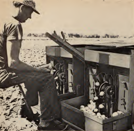
Fig. 2.—Vue des chaînes et des godets distributeurs sur la planteuse à godets. C'est probablement la planteuse qui offre le moins de danger de contaminations et de meurtrissures des tubercules.
