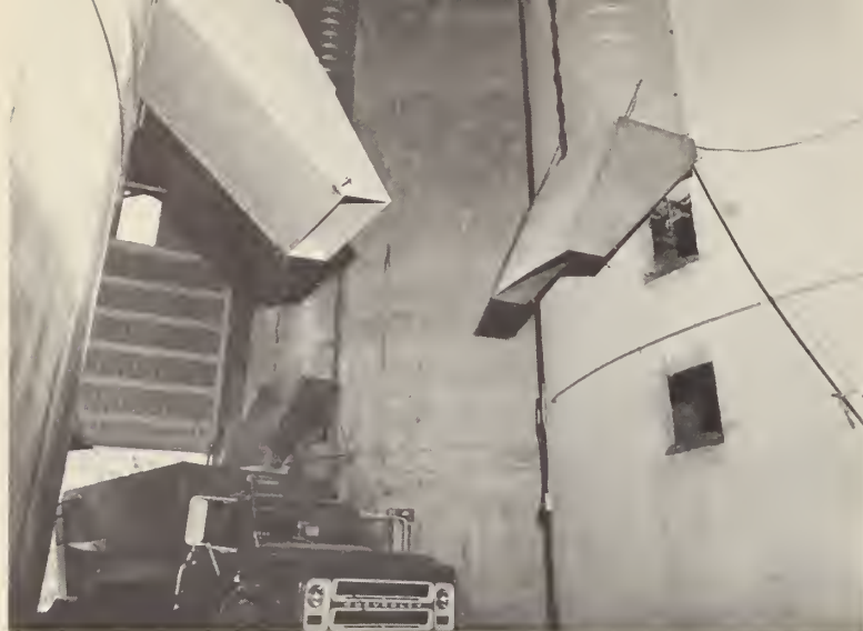
Mixing and weighing truck automatically loaded with silage La goulotte d'un des silos déverse l'ensilage dans ce camion qui pèse et mélange automatiquement les aliments.
