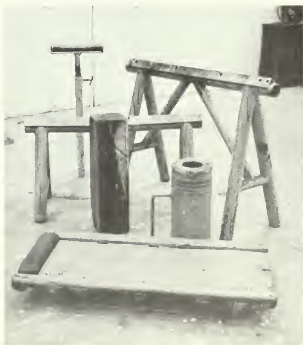
Figure 8 Chandelles construites à l'aide de pièces de rebut
