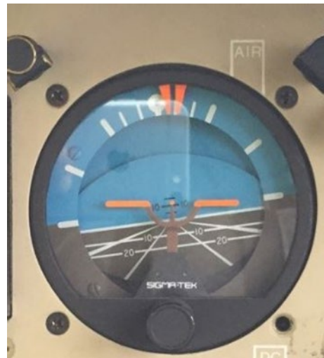
Figure 2. Indicateur d'assiette du côté droit sans dépression appliquée (Source : Air Tindi Ltd.)
