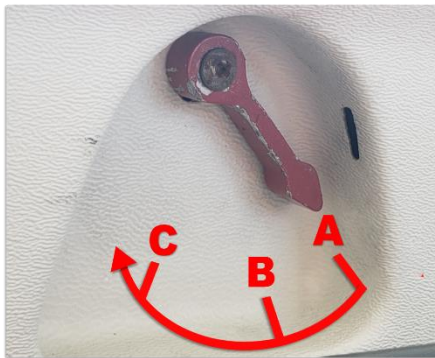
Figure 10. Mouvement de la poignée du hublot issue de secours du point A au point C avec le point de résistance B (Source : BST)
