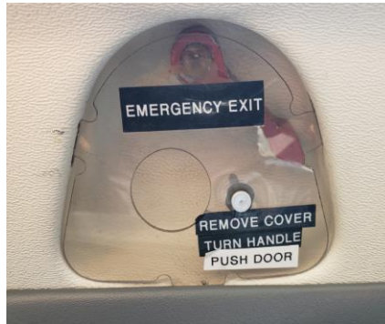
Figure 7. Poignée du hublot issue de secours recouvert de la plaquette de plastique (Source : BST)
