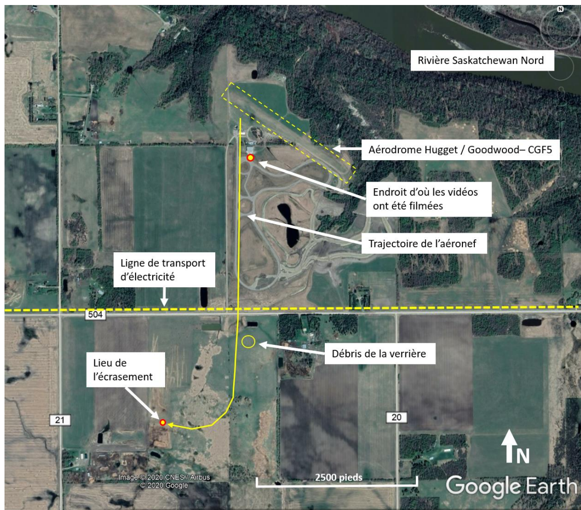
Figure 1. Carte illustrant la trajectoire de vol de l'aéronef dans l'événement à l'étude, la ligne de transport d'électricité et le lieu de l'accident (Source : Google Earth, avec annotations du BST)
