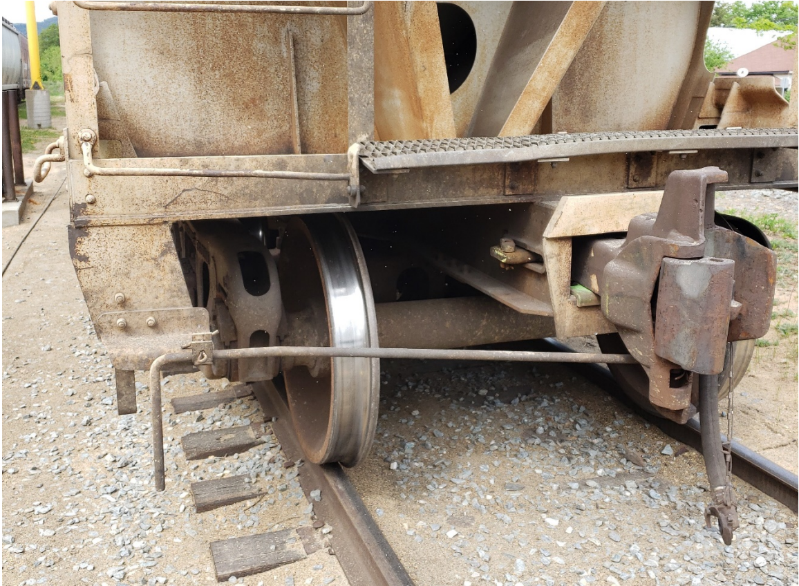
Figure 4. Levier de dételage typique d'un wagon de marchandises (Source : BST)
