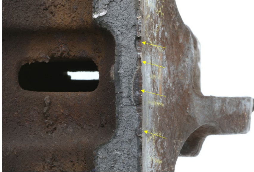
Figure 10. Fissures de fatigue (Source : BST)
