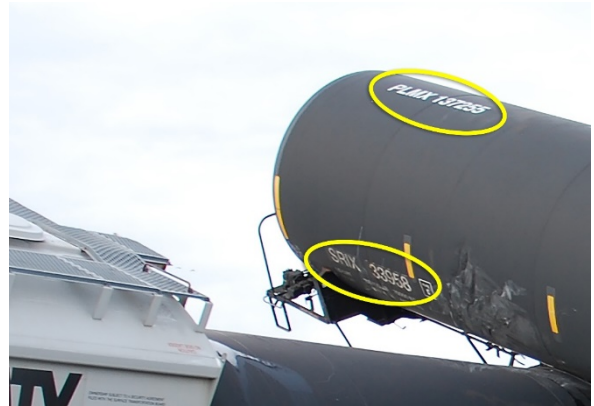
Figure 11. Marques de wagon sur le wagon-citerne SRIX 33958 (Source : Chemin de fer Canadien Pacifique, avec annotations du BST)
