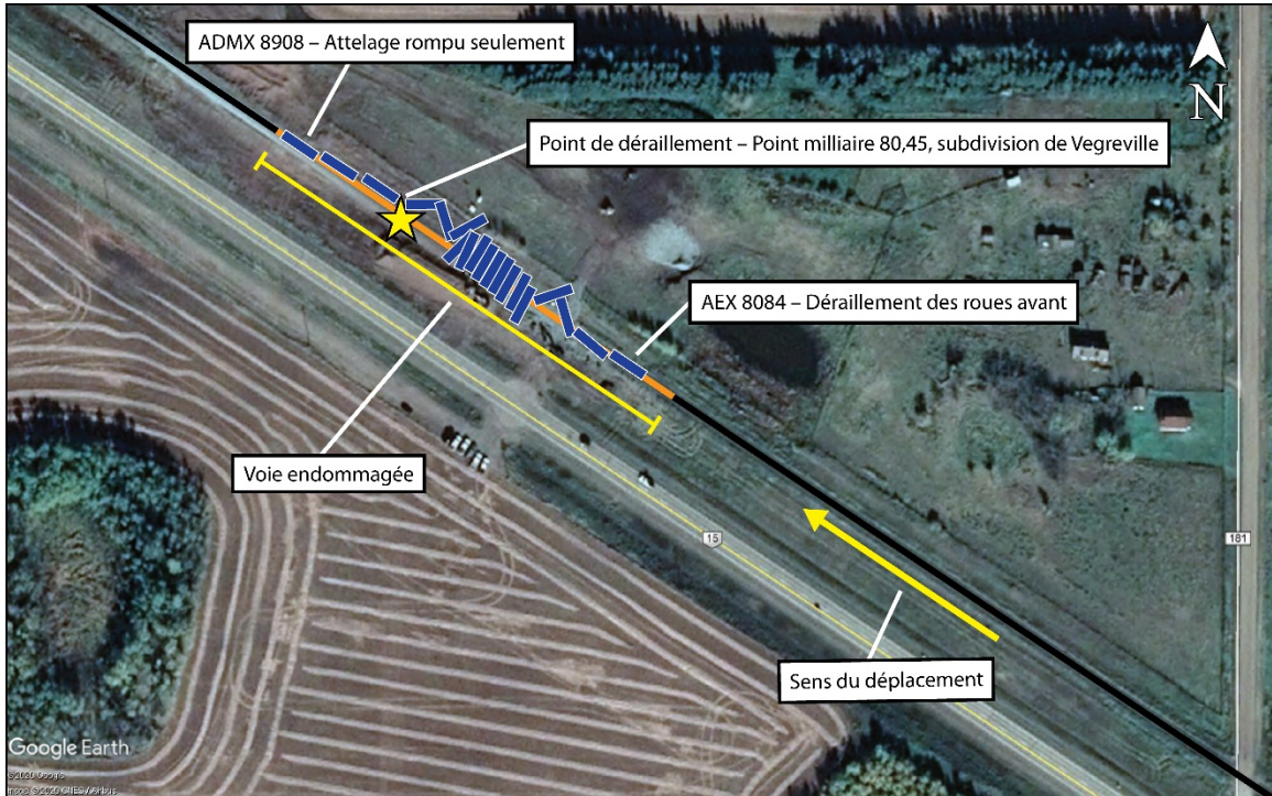
Figure 2. Image satellite de l'emplacement du déraillement (Source : Google Earth, avec annotations du BST)
