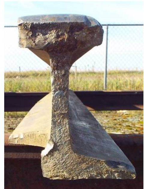
Figure 4. Écrasement des abouts de rail sur le rail rompu (Source : Compagnie des chemins de fer nationaux du Canada)
