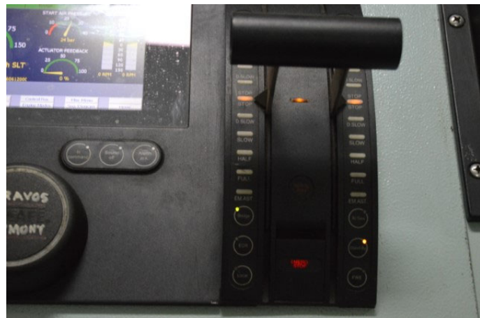
Figure 6. Système combiné du propulsion et de transmission d'ordres (LTU) à bord du Caravos Harmony (Source : BST)
