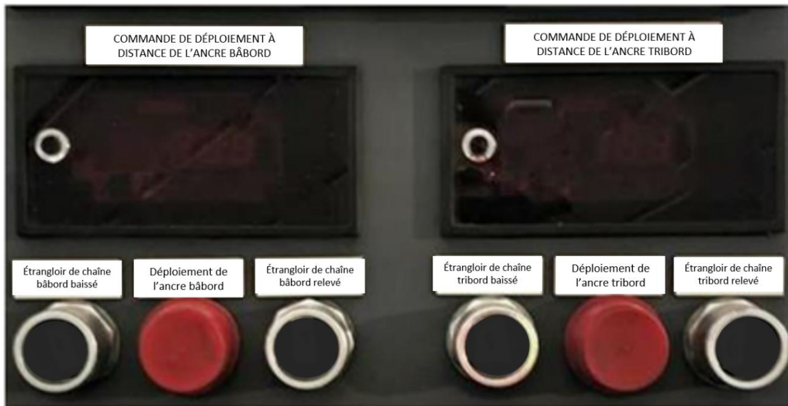
Figure 6. Commandes de déploiement à distance des ancres (Source : BC Ferries, avec annotations du BST)
