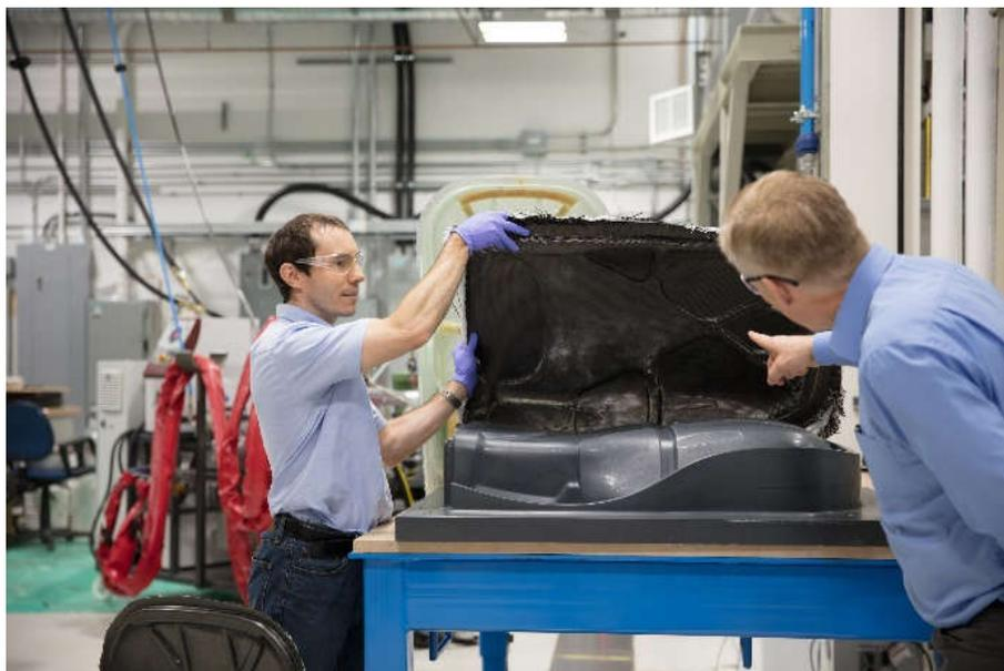
Photo ci-dessus : un chercheur d'ATS et un membre du groupe de R-D SNAP sur les matériaux composites examinent une pièce de véhicule moulée par compression.
