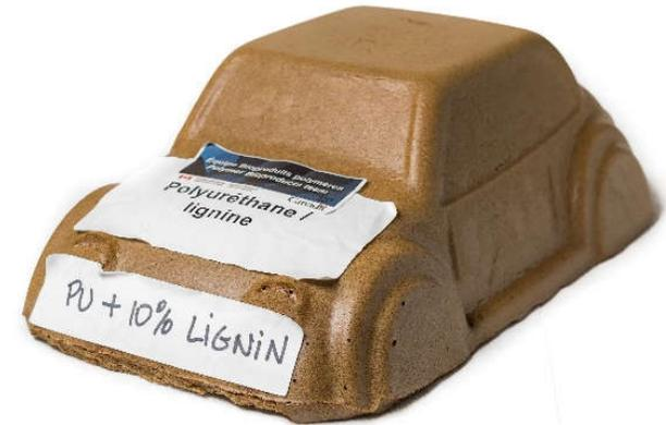
Ci-dessus : Exemple de mousse isolante contenant de la lignine qui a été extraite de déchets générés par le secteur de fabrication de pâtes et de papier
