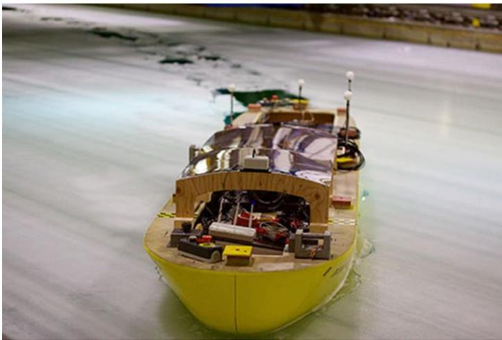
Essai de la maquette de brise-glace à St-John's.
