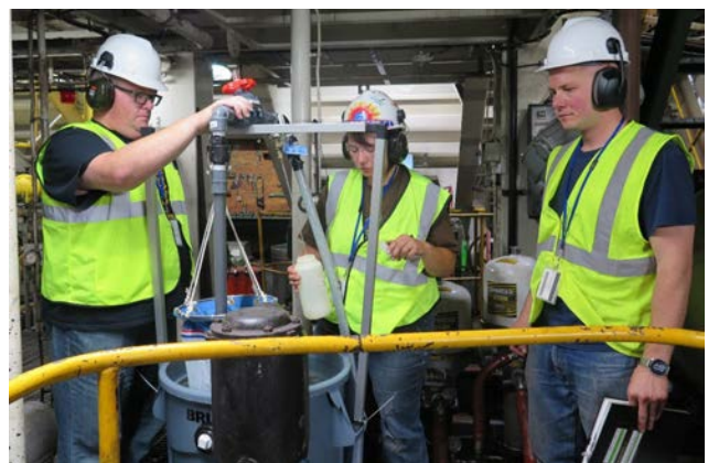
Des scientifiques de Great Waters Research Collaborative recueillent des échantillons d'eau de ballast à bord du M/V Edgar B. Speer en août 2017, dans le cadre de l'étude de surveillance de l'eau de ballast des navires dans les Grands Lacs. Source : GWRC.
