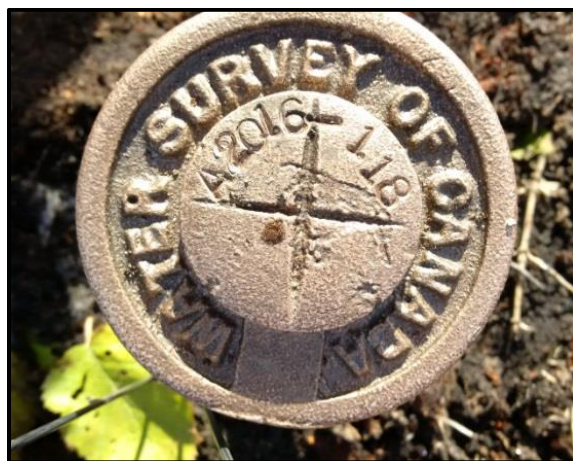
Figure 2. Photo d’un repère de RHC installé à l’horizontale montrant son code d’identification.
