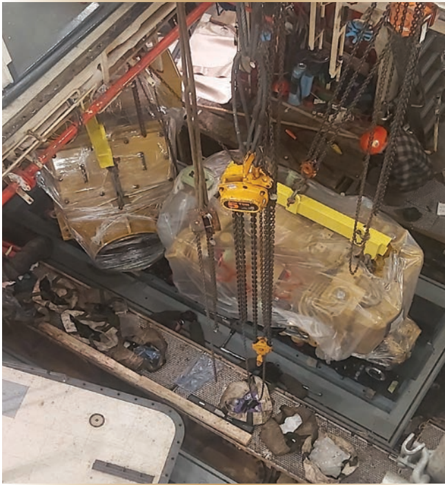
Figure 5. Un nouveau moteur et un nouveau groupe électrogène sont placés sur le radeau des machines.
