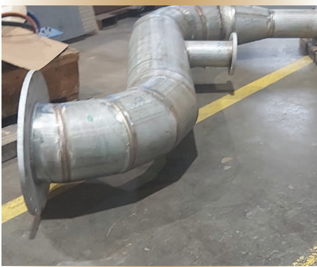
Figure 7. Une partie de l'entrée d'air et de l'échappement du nouveau moteur est fabriquée par l'installation de maintenance de la flotte Cape Scott.
