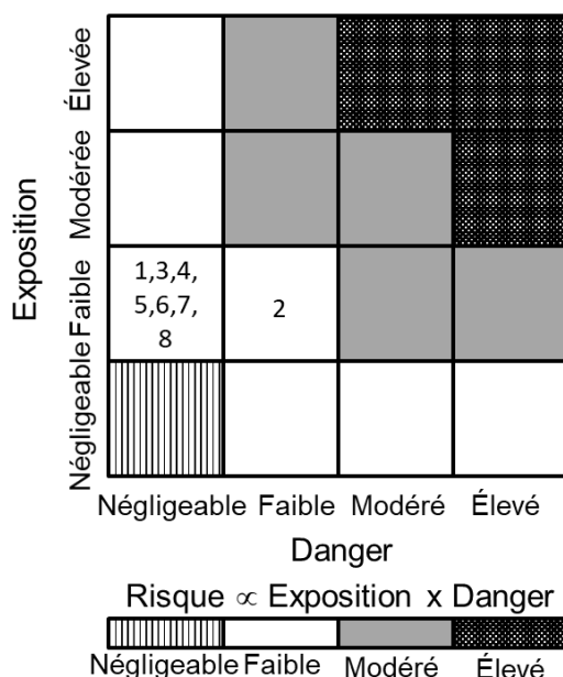
Figure 2.3 : Matrice des risques pour illustrer comment l'exposition et le danger sont intégrés pour établir un niveau de risque dans l'évaluation des risques pour l'environnement. Les évaluations des risques associées aux composantes de danger au niveau d'exposition évalué sont désignés par des chiffres : 1) risques liés à la toxicité pour l'environnement; 2) risques liés à la transmission horizontale de gènes; 3) risques liés aux interactions avec d'autres organismes; 4) risques liés à l'hybridation; 5) risques en tant que vecteur de maladies; 6) risques pour le cycle biogéochimique; 7) risques pour l'habitat; 8) risques pour la biodiversité.
