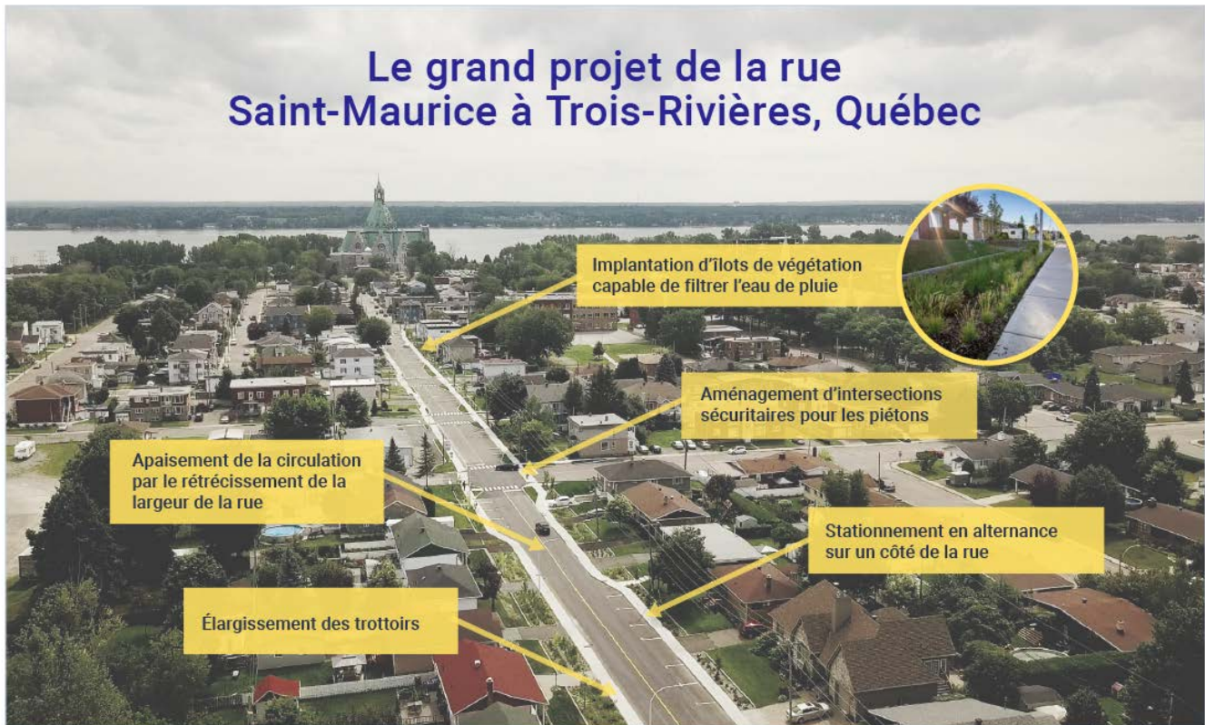
Figure 2.17 : Un aperçu des mesures d'adaptation et d'atténuation mises en œuvre grâce à l'amélioration de la rue Saint-Maurice à Trois-Rivières, QC. La photo est une gracieuseté de la Ville de Trois-Rivières.
