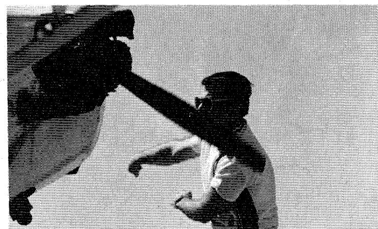
On doit faire tourner l'hélice manuellement pour que le moteur démarre; attention aux doigts.
