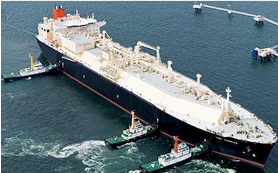
**Transporteur GNL typique de 216 000 m<sup>3</sup> avec des réservoirs de confinement à membrane**
