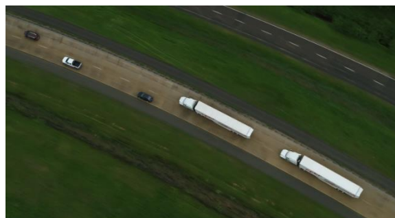
Figure 7. Photo aérienne d'un essai sur piste d'un peloton de 2 camions avec l'Université d'Auburn.
