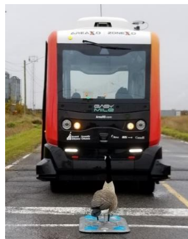
Figure 13. Essai de navette automatisée à basse vitesse pour valider la réaction des capteurs à une bernache canadienne artificielle.
