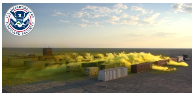
Figure 10. Essai sur le terrain de rejet de chlore à grande échelle avec les services d'urgence de l'Université d'Utah Valley, montrant le nuage vert de rejet toxique et l'environnement d'essai.
