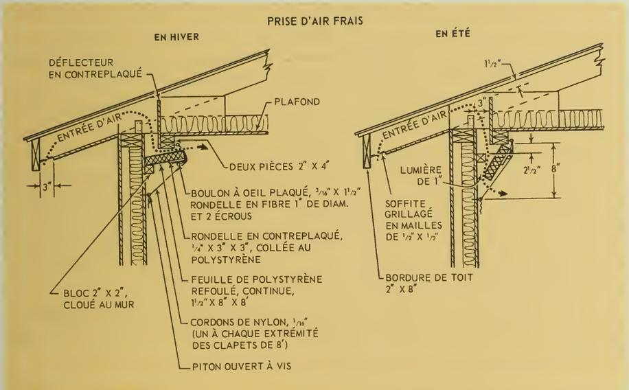
Figure 2. Prises d'air manuelles à échappement horizontal ou vertical.
