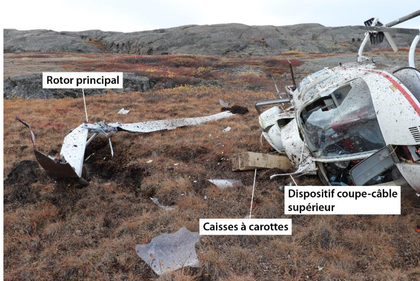
Figure 1. Photo de l'épave montrant l'hélicoptère sur son côté droit, le rotor principal et les caisses à carottes (Source : Gendarmerie royale du Canada)
