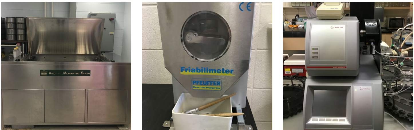
Système de micromaltage Phoenix (à gauche), friabilimètre (au milieu), et densitomètre (à droite) dans les laboratoires de maltage et d'analyse du malt du Laboratoire de recherches sur les grains.
