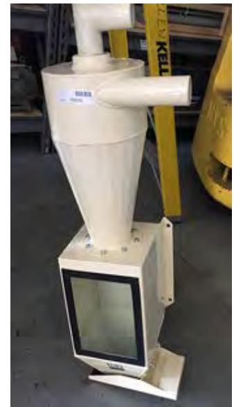
Figure 16 : Capteur d'échantillon utilisant une pompe à vide à cyclone
