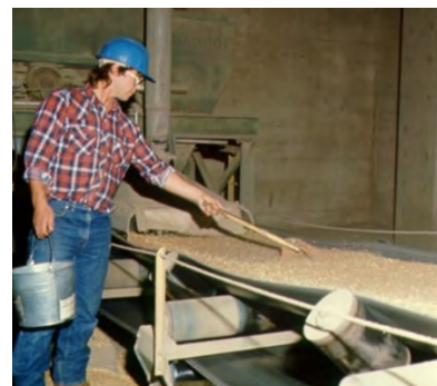
Figure 32 : Échantillonnage du grain d'une courroie horizontale
