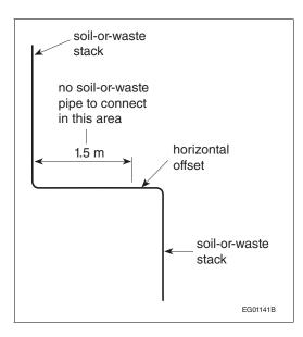
Figure A-2.4.2.1.(2) Soil-or-Waste Pipe Connections
