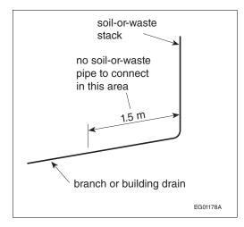
Figure A-2.4.2.1.(4) Soil-or-Waste Pipe Connections
