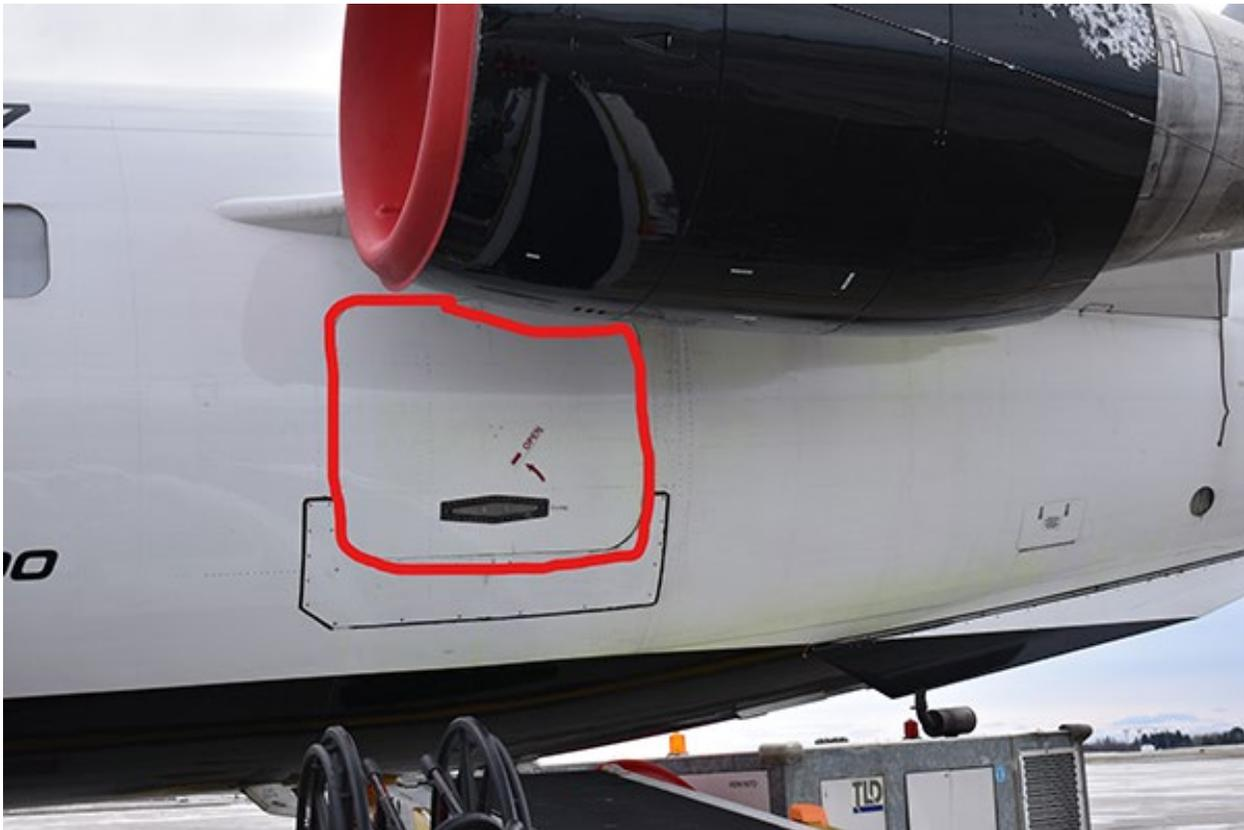
**Illustration 5. Exemple d'une porte de soute où le moteur en réduit légèrement les dimensions réelles, comme le montre le trait en rouge**
