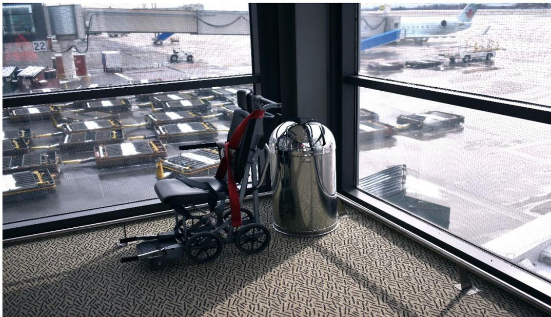
**Illustration 3. Fauteuil d'allée type (c.-à-d. modèle Washington) dans lequel un voyageur ayant une aide à la mobilité motorisée doit s'asseoir lorsqu'il embarque dans l'avion**
