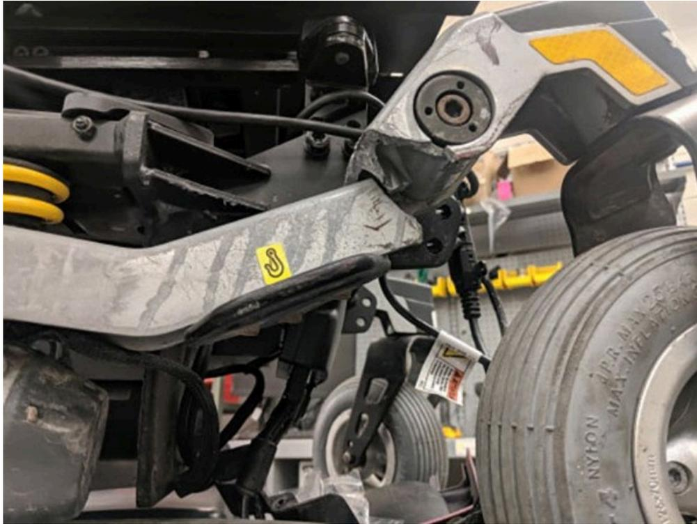
**Illustration 14. Photo d'une aide à la mobilité endommagée et impossible à réparer en raison d'un bris au châssis (on peut voir l'autocollant indiquant un point d'attache)**
