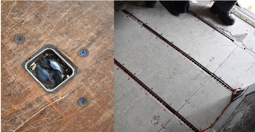
Illustration 10. Exemples d'ancrages de plancher dans la soute
