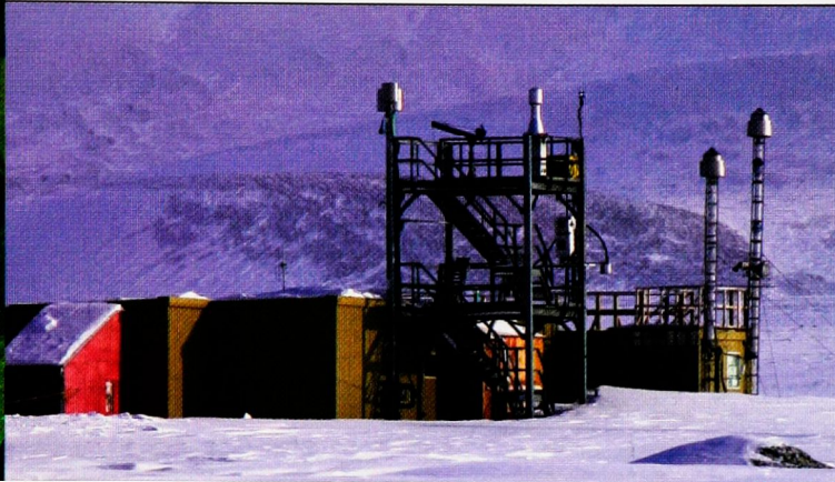
À l'observatoire du SMC à Alert, au Nunavut, des techniciens mesurent les concentrations des gaz à effet de serre, des substances appauvrissant la couche d'ozone et des aérosols chaque jour.
