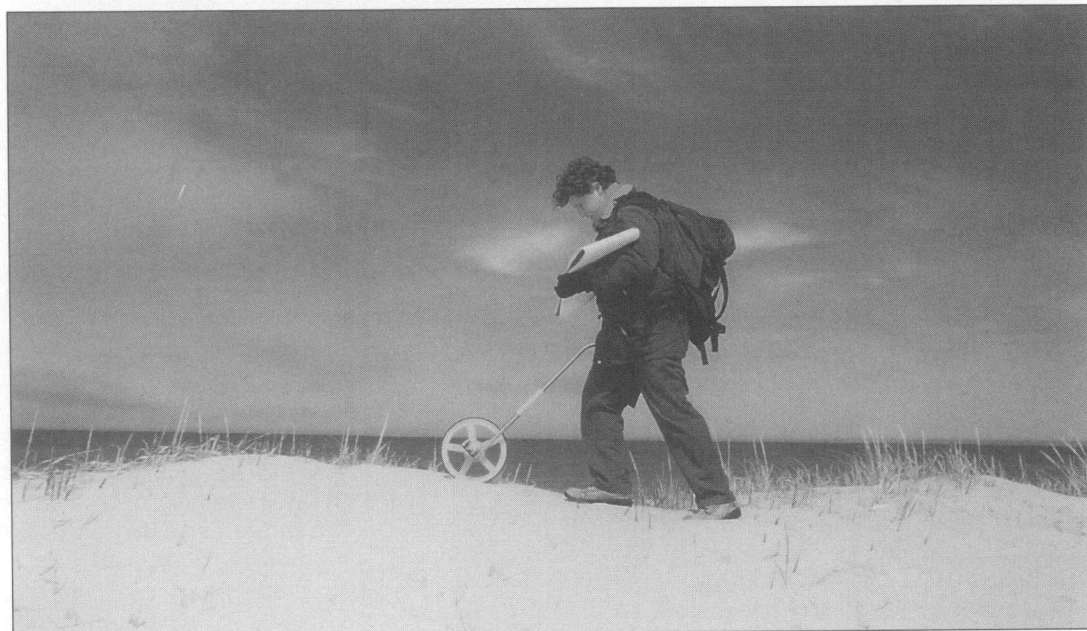
Un levé électromagnétique (voir l'encadré) -- pour trouver les emplacements où sont enfouis les sacs de résidus huileux.
