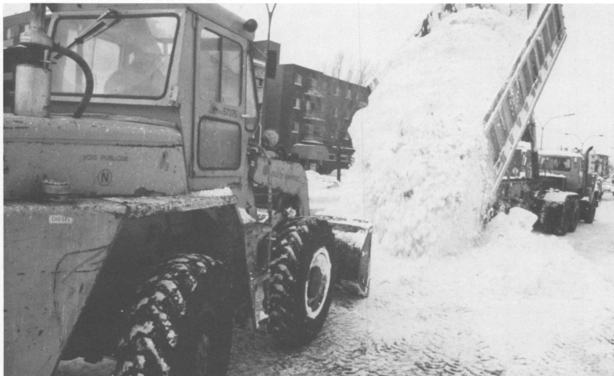
Déchargement de la neige dans le réseau d'égouts: le tracteur-chargeur fait tomber la neige dans le collecteur
