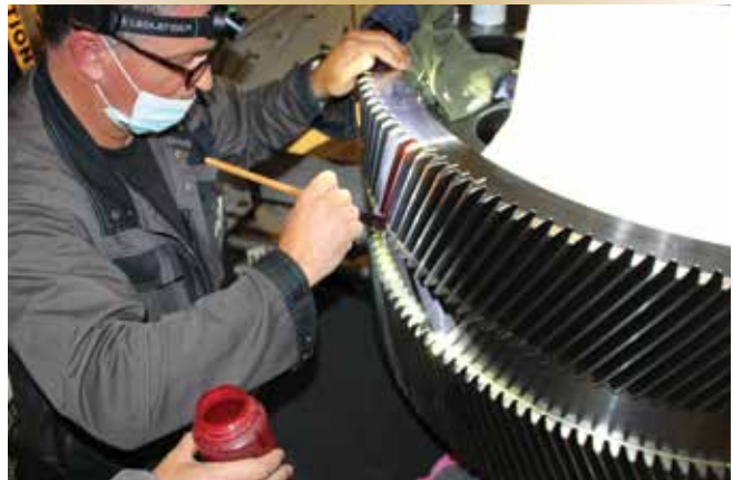
Figure 3. On applique du rouge à marquer de Dykem sur l'échantillon de dent pour vérifier la justesse de l'engrènement dans des conditions de charge opérationnelle en mer.
