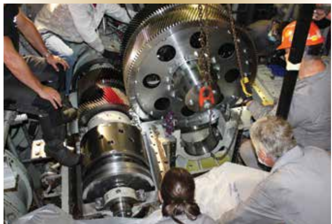
Figure 4. Les vérificateurs d'engrenage de la formation Patti Fraser et Stéphane Chouinard observent l'installation du nouvel engrenage.
