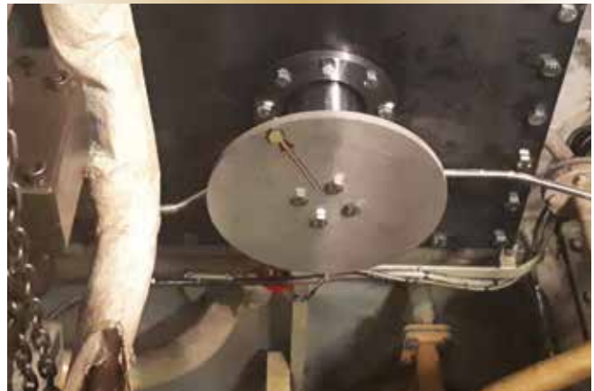
Figure 1. Bout d'arbre de transmission avec la marque d'orientation radiale pour aider à déterminer la source du bruit.
