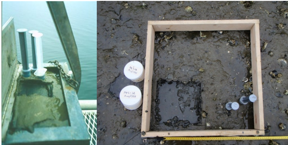
Figure 3 : Seringues insérées dans un échantillon prélevé au moyen d'une benne d'échantillonnage de type Ponar. Un sous-échantillon de deux centimètres de profondeur a été prélevé après l'insertion des seringues. Notez les sédiments anoxiques noirs sous-jacents à la couche de surface oxygène (environ trois millimètres de profondeur) [photo de gauche]; seringues insérées et sous-échantillon de surface dans un quadrat d'échantillonnage intertidal (0,25 m 2 ) [photo de droite].
