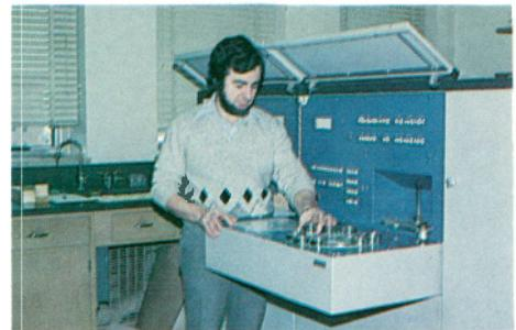
M. Rousseau chargeant des échantillons dans le spectromètre à rayons X
