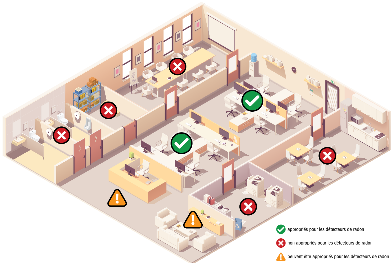
Figure 3. Emplacements potentiels pour les tests de radon dans un environnement de bureau. Les emplacements qui peuvent être appropriés (⚠) doivent être évalués pour s'assurer que les détecteurs ne seront pas déplacés s'ils sont déployés dans ces emplacements.
