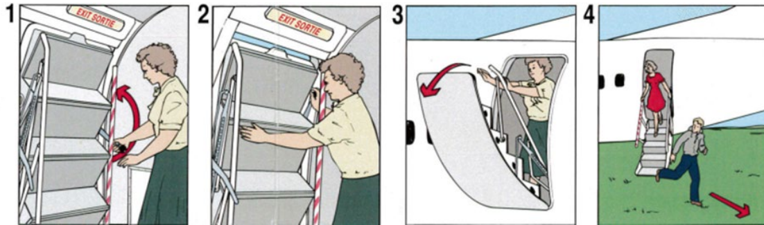
Figure 27. Instructions illustrées sur la façon d'ouvrir la porte de sortie principale, figurant sur la carte des mesures de sécurité de l'aéronef (Source : West Wind Aviation L.P.)
