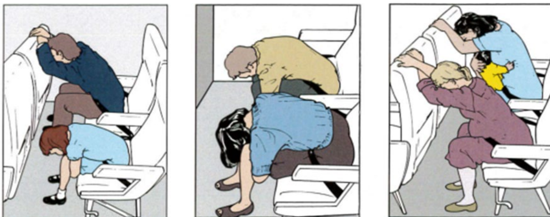
Figure 23. Position de protection recommandée à bord de l'aéronef ATR 42, comme illustré sur la carte des mesures de sécurité (Source : West Wind Aviation L.P.)
