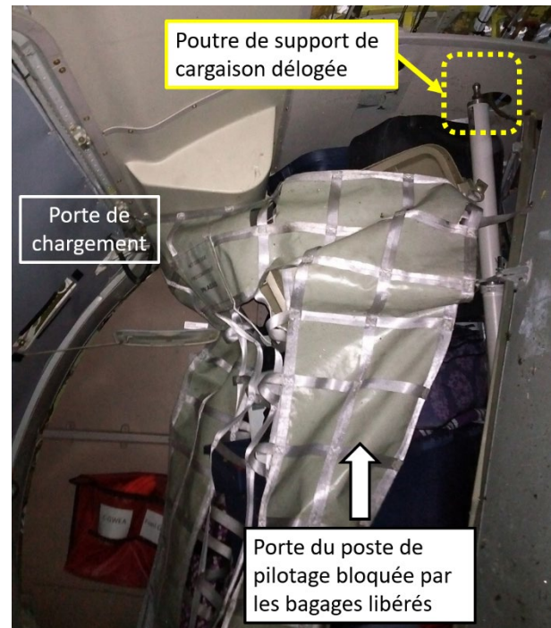
Figure 32. Sortie principale du poste de pilotage bloquée par les bagages libérés lorsque la poutre de support de cargaison s'était délogée (Source : BST)
