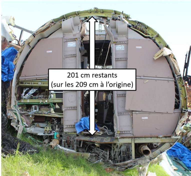
Figure 12. Vue transversale du fuselage avant, juste derrière le poste de pilotage, observé vers l'avant, prise lors d'un examen hors site ultérieur (Source : BST)
