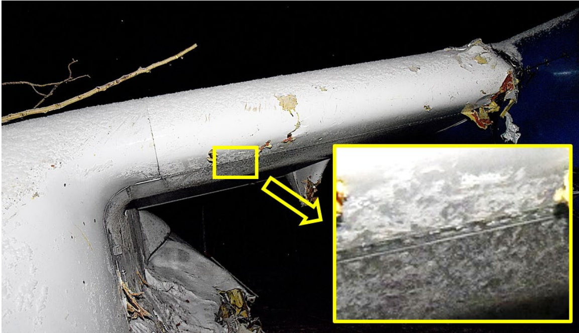
Figure 18. Photo de l'aile gauche avec image en médaillon montrant la contamination de surface sur le bord d'attaque inférieur près du fuselage (Source : Gendarmerie royale du Canada, avec annotations du BST)
