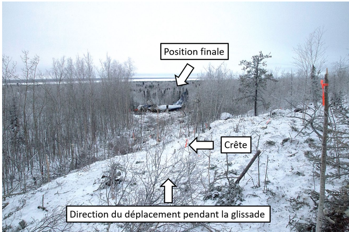
Figure 8. Photo montrant la trajectoire de glissade de l'aéronef par-dessus la crête (Source : BST)
