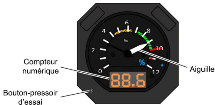
Figure 4. Indicateur du régime d'hélice montrant le compteur numérique, le bouton-poussoir d'essai et l'aiguille (Source : Avions de Transport Régional, Calm Air Flight Crew Operations Manual, avec annotations du BST)
