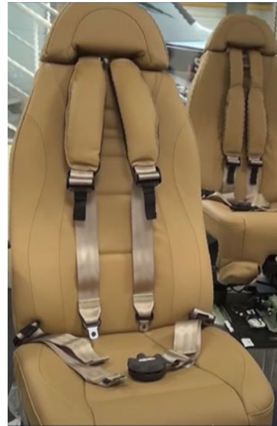
Figure 5. Ensemble de retenue du siège d'équipage avec coussins gonflables intégrés aux ceintures-baudriers (sièges retirés de l'aéronef) (Source : Daher TBM)
