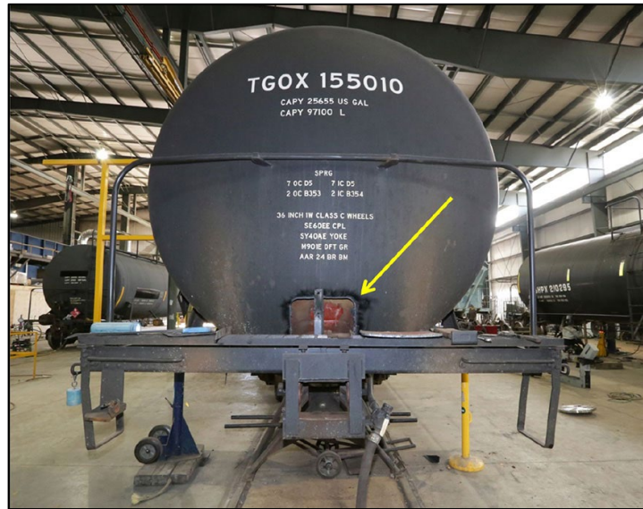
Figure 6. TGOX 155010 préparé pour une inspection, sans enveloppe externe ni isolant (flèche)
