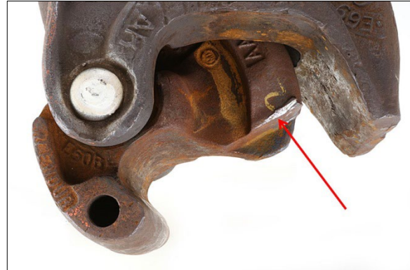
Figure 12. Vue en plan de la déformation sur l'extrémité de la mâchoire
