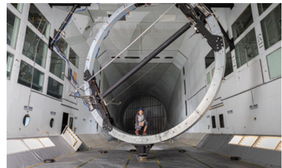
Le banc d'essai pluie-vent permet l'étude des vibrations des haubans sur des modèles grandeur nature
