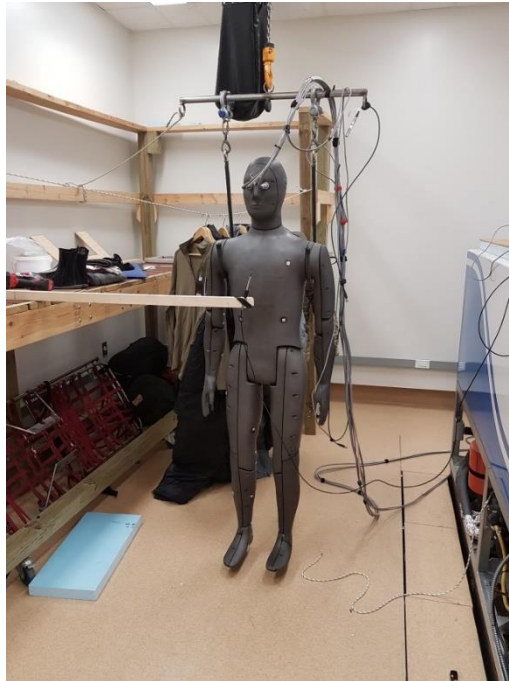
Figure 1: Thermal manikin NEMO.
