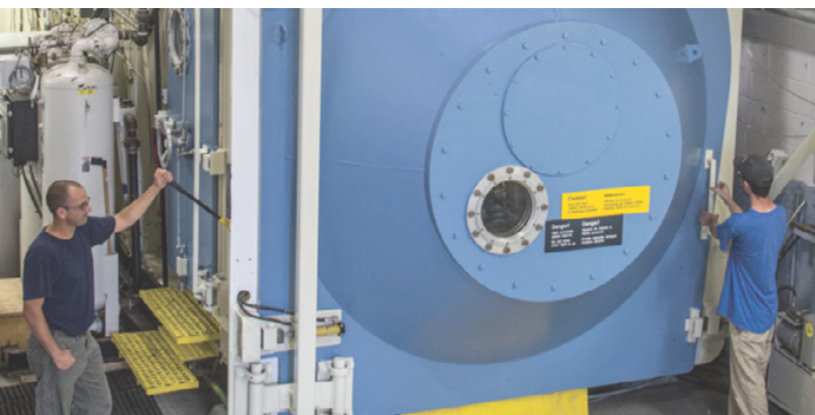
L'installation de recherche en altitude du CNRC permet d'évaluer le rendement de moteurs et de composants dans des conditions simulées et au moyen de divers carburants.
