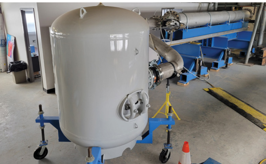
Le super canon à drones du CNRC sert à effectuer de la recherche et des essais d'impacts de drones.
