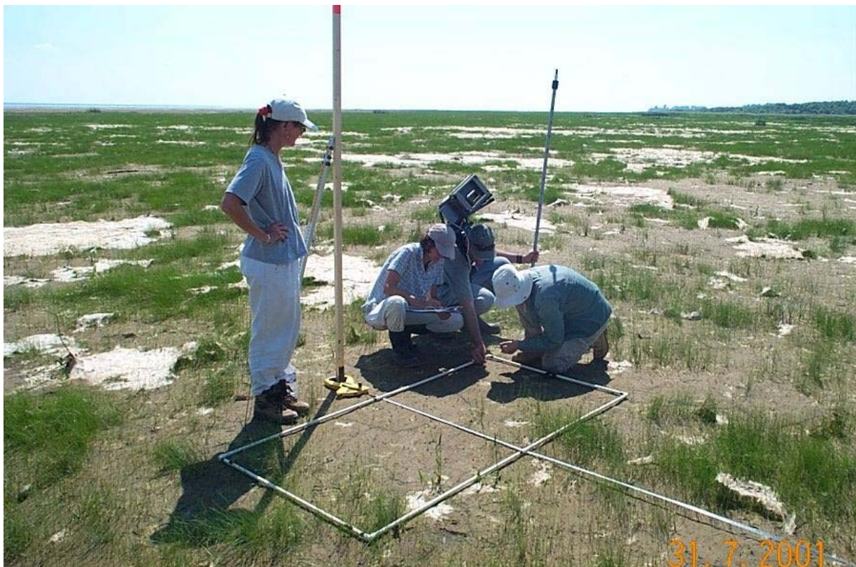
Figure 7 Dimension d'un quadrat d'échantillonnage (1 m × 2 m) et positionnement le long du transect
