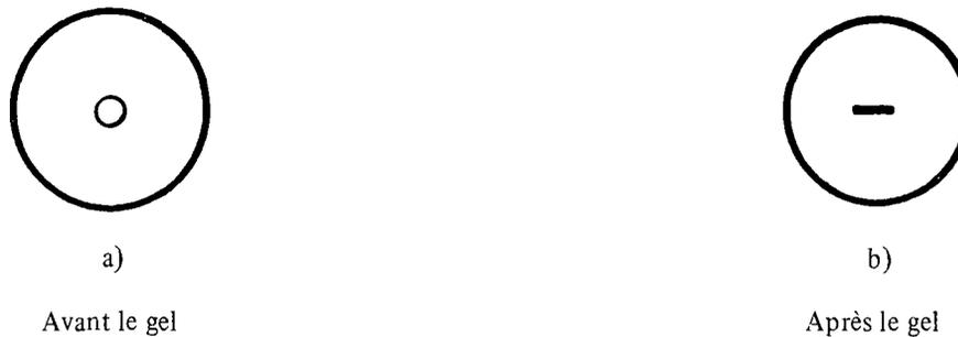
Figure 17 Rupture d'un tube intérieur de dégel
