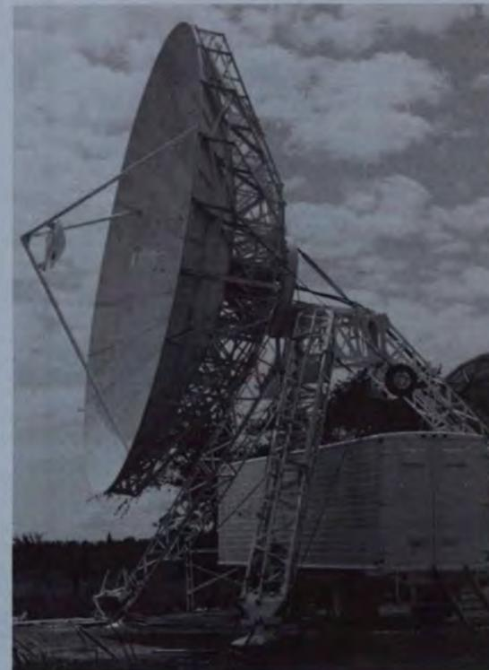
Antenne parabolique de 10m de diamètre en aluminium pour les expériences au moyen du satellite Symphonie. La remorque de 18m de longueur loge tout le matériel électronique. L'antenne peut être montée sans aide mécanique.
