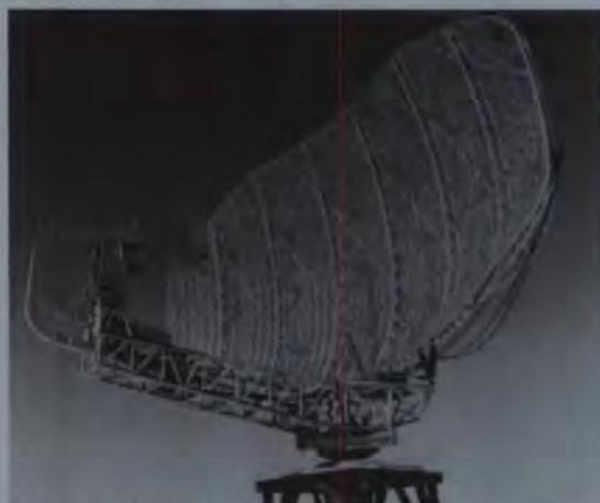
Antenne de surveillance radar, recevant les ondes en bande S; elle a été construite par Andrew pour l'Inde.
