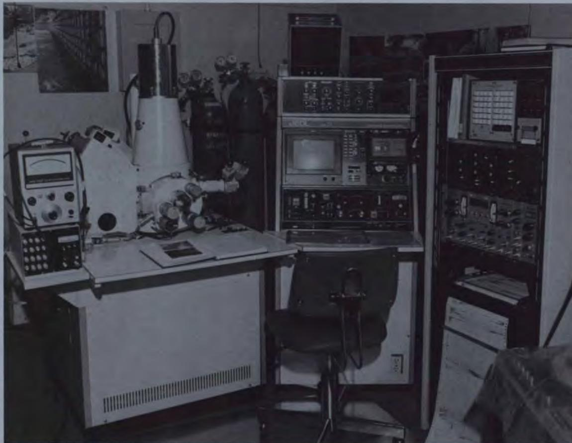
Microscope électronique à balayage associé à un analyseur intégral à microsonde, utilisé au Centre de recherches sur les communications pour déterminer la fiabilité et analyser les pannes de matériels et dispositifs électroniques.
