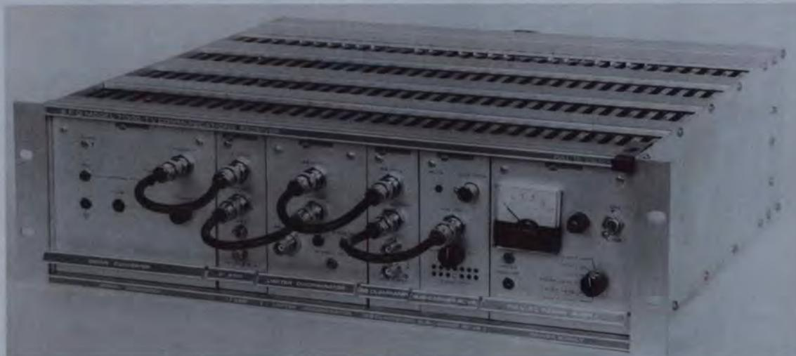
Récepteur de télévision et de télécommunication par satellite. Il a été conçu et construit pour fonctionner dans les 3,7 à 4,2 GHz.
