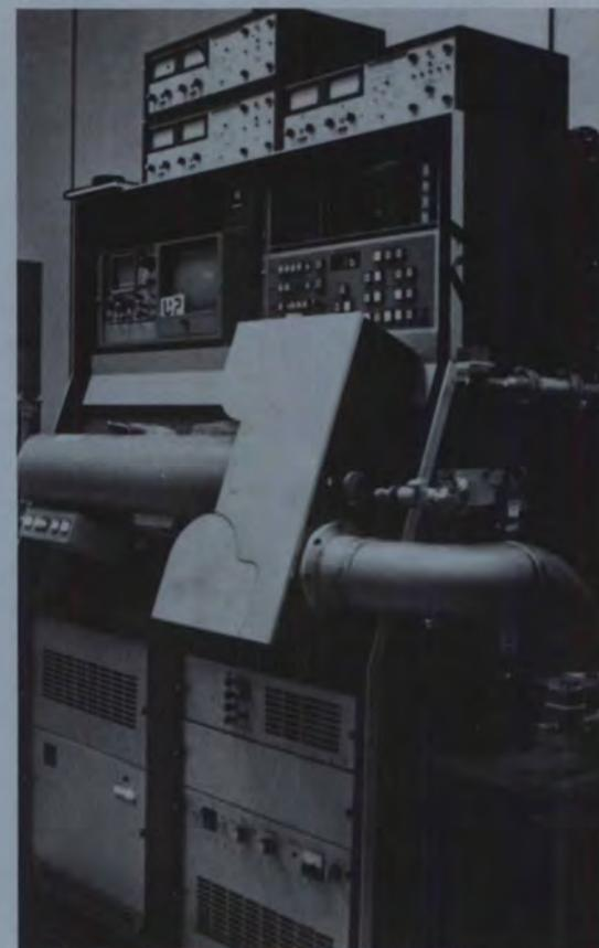
Toutes les images à grande résolution en provenance de LANDSAT et traitées par le CCT ont été obtenues sur ces enregistreurs à faisceau d'électrons. Les électrons y dessinent les images sur un film 70 mm.
