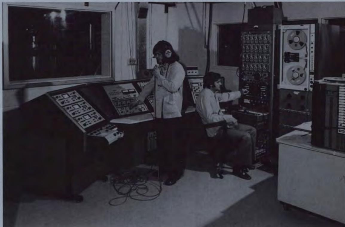
Salle de commande de l'installation d'essais de vibration du Laboratoire David Florida. Les accélérations et les contraintes peuvent être surveillées en même temps sur 42 points de contrôle différents. Le pupitre peut aussi obéir
