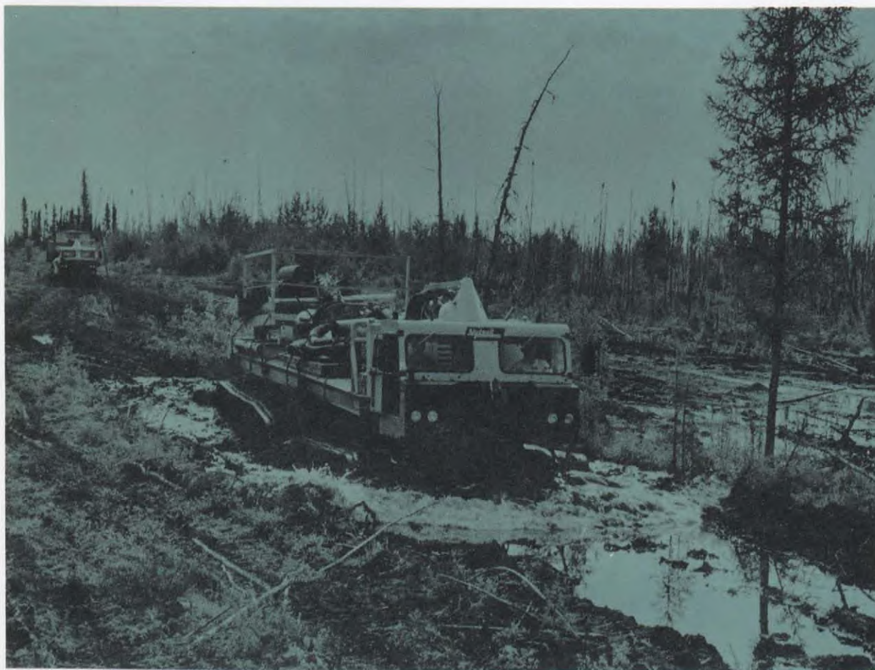
Le Nodwell 110, chargé d'équipement de forage, se déplace facilement sur la route détremée et boueuse construite dans une région de muskeg.
