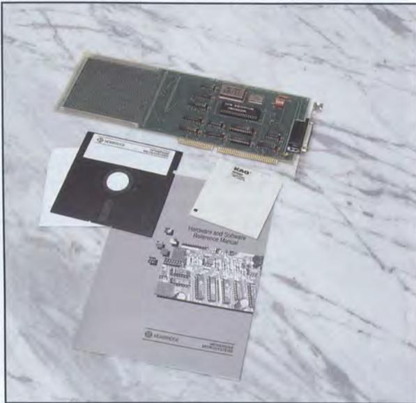
Une carte de communications en série sécuritaire pour le PCXT/AT. Ce produit OEM est basé sur le processeur d'encodage de données CA34C168 et le générateur de bit aléatoire RBG 1210.
