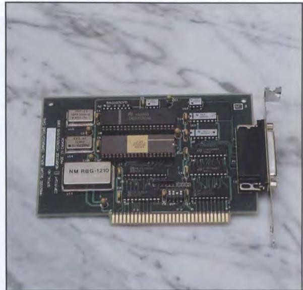
Un système de développement basé sur le EDS-001D PC utilisé pour le développement des applications d'encodage d'intercommunications par l'entremise du processeur d'encodage de données CA34C168.
