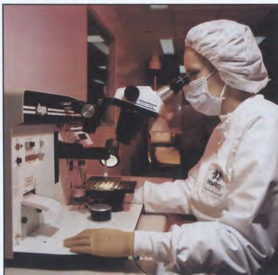
Un opérateur du processus puce sur carte au poste de contrôle de qualité de soudure de fil.
