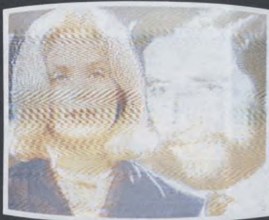
BROUILLAGE CAUSÉ PAR UNE STATION ÉMETTRICE MF
