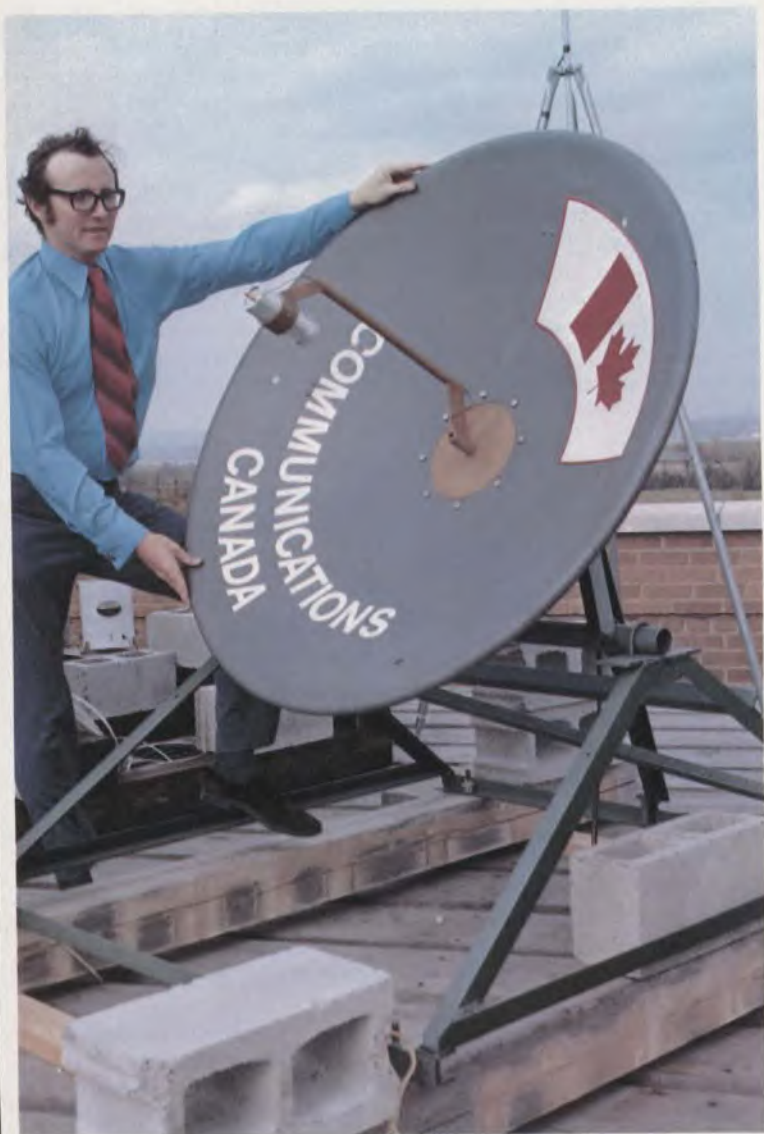
Figure 67 Terminal Hermès avec antenne de toit de 1,2 m de diamètre servant à la réception télévisuelle directe à domicile.
