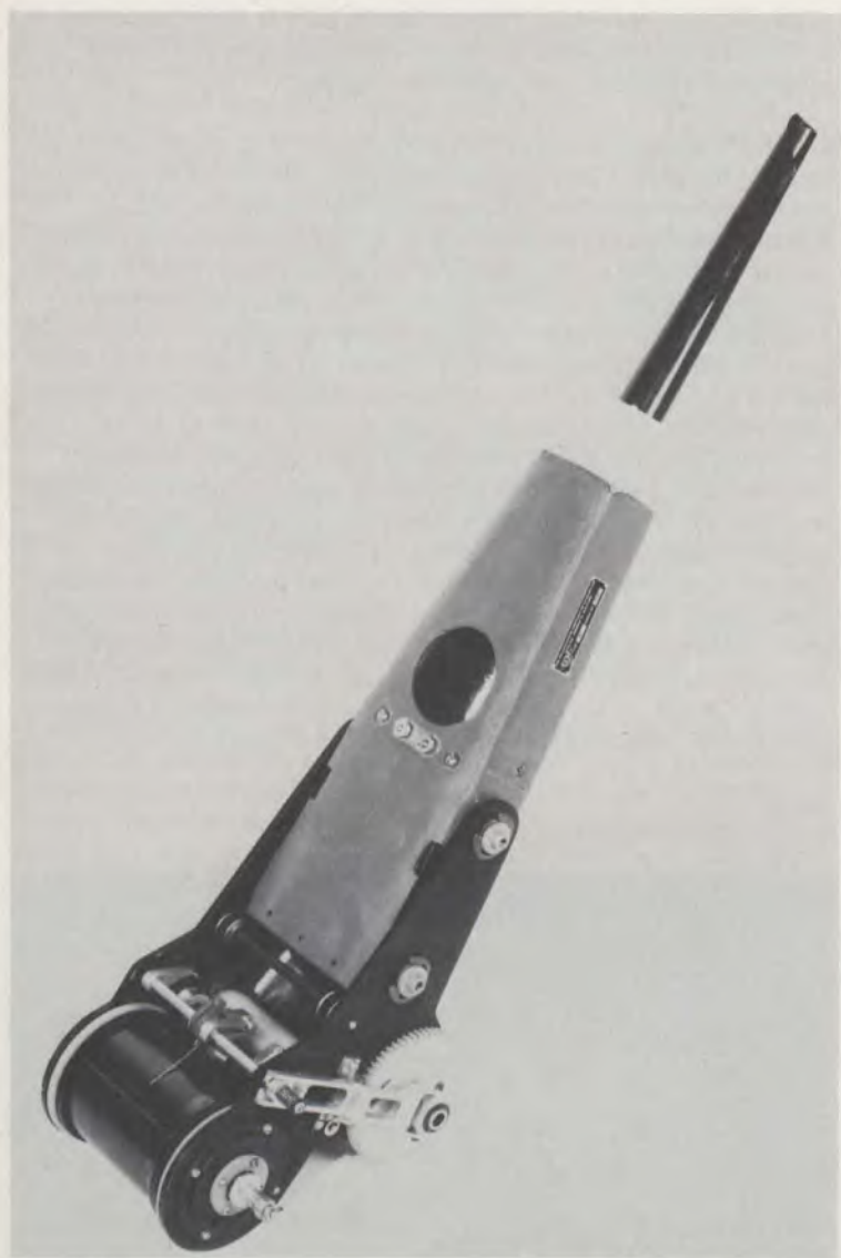
Figure 20 Élément d'antenne extensible tubulaire (STEM) — mis au point à partir des dispositifs d'antenne utilisés sur Alouette I.
