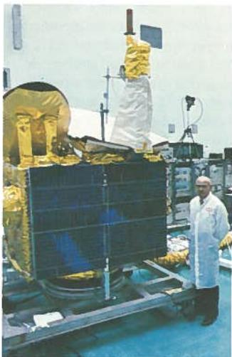
*Anik B, le premier satellite hybride de télécommunications à fonctionner dans les bandes de 4-6 GHz et 12-14 GHz, au Kennedy Space Center peu avant son lancement.*
