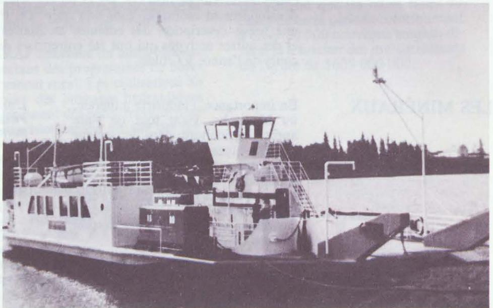
Alors que, dans le cadre de l'entente sur les terres septentrionales, l'on est en train de construire des routes menant à Split Lake et Cross Lake, l'accès à ces localités se fait au moyen de bacs en acier, capables de transporter 16 véhicules en plus des passagers.
